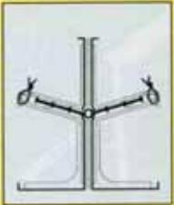
Zur Lagesicherung das Oberteil mit dem Unterteil verlöten.
